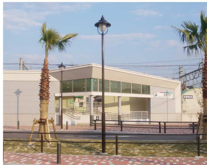
■歩道用照明器具：HS-525 型 ・光源 : LED (白色) ・器具高 : 4.5m
