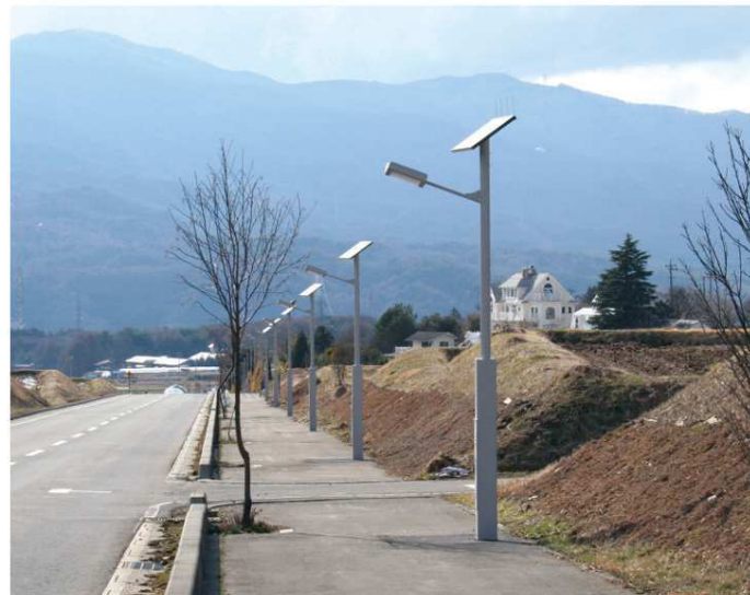
■歩道用照明器具：HS-304 型 ・光源：LED（白色） ・器具高：3.5m
