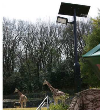
■歩道用照明器具：HS-306 型 ・光源：LED（白色） ・器具高：3.5m
